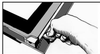
Поднимите конструкцию, чтобы снять раму со стеклом.
