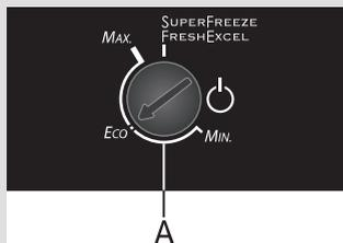
Le réglage de la température du réfrigérateur a une incidence indirecte sur celle du congélateur.
