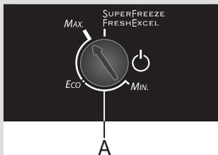
Pour mettre l'appareil en marche, tournez le bouton du thermostat (A) vers la position **MAX** ; pour le mettre à l'arrêt, positionnez le curseur en face de l'icône Marche/Arrêt  $\text{⏻}$  (l'appareil est à l'arrêt, mais il demeure sous tension).
