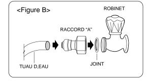
n'oubliez pas de mettre les jointsdans le raccord et l'adaptateur
